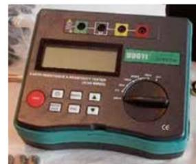
**TELURÓMETRO:** Nos permite verificar la resistencia de puesta a tierra de la instalación. Seguridad.
